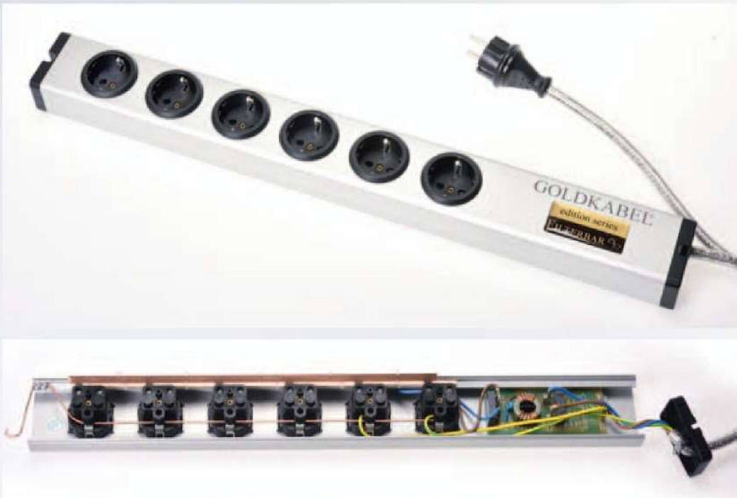
Klassisch, aber gut gemacht: Über eine Zuleitung mit 1,5 Metern geht es an eine kompakte Platine mit zentraler Drossel. Darauf folgen sechs hochwertige Buchsen in Aluminium verschraubt.
