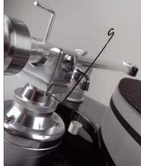
Die Gegenkraft für den typischen Drang des Tonarmes nach innen wird mittels Gewicht und Fadenzug kompensiert (Antiskating)
