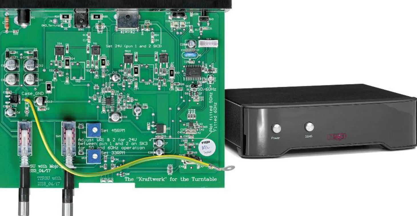
Einblick in die Steuerplatine des NEO PSU Netzteils. Hier arbeiten ICs, Transistoren und Digitaltechnik Hand in Hand, um einen perfekten Gleichlauf des P6 zu gewährleisten. Fast schon rührend mutet der eine, klassische Widerstand an
