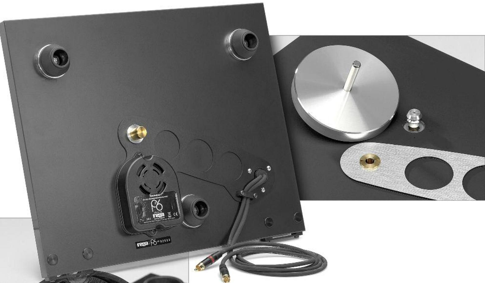
Oben: Auf dem mittleren Bild sieht man die schlichte Schönheit des Konzepts. Starr und damit ruckelfrei befindet sich das Lager auf derselben Verstrebung wie der Arm. Daneben erkennen wir den neuen, aus einem Stück Aluminium gedrehten Subteller sowie den einteiligen neuen Pulley
