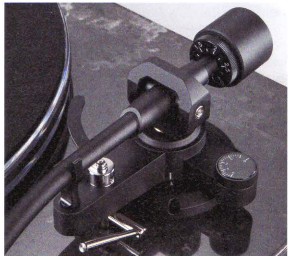
Der S-Tonarm hat ein Gegengewicht mit Skala sowie eine stufenlos einstellbare Antiskating. Nach Lösen einer Schraube lässt sich die Tonarmhöhe verändern.
