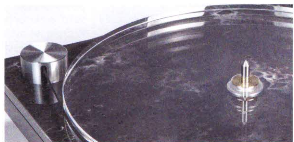
Ein langer Flachriemen umschlingt den glasklaren Acrylteller. Der außen am Chassis angebrachte Motor wird von einer silbrigen Kuppel verdeckt.
