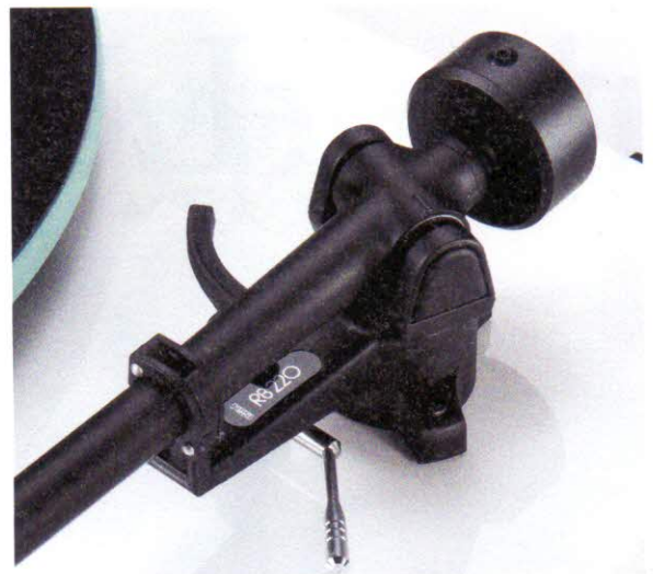
Das Gegengewicht hat keine Skala. Einmal ganz rum entspricht exakt 20 Millinewton. Die Antiskating zieht den geraden Arm mit voreingestellter Kraft nach außen.
