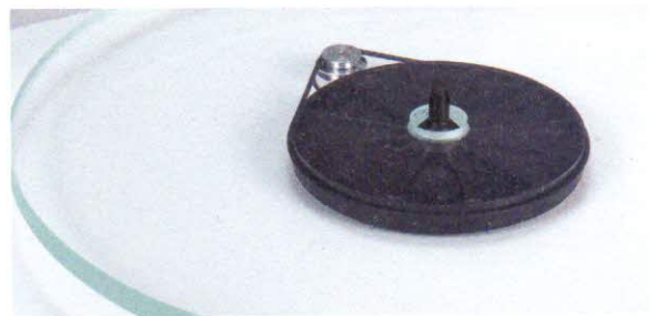
Unter dem Glasteller wird dessen kleine Kunststoffauflage sichtbar, die ein kurzer Rundriemen antreibt. Im Normalfall verdeckt die Filzmatte das Schauspiel.
