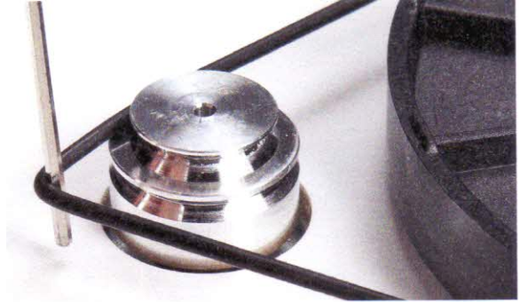
Um die Geschwindigkeit zu wechseln, muss beim P2 der Teller abgenommen und der Riemen manuell zwischen den beiden Pulley-Scheiben umgelegt werden.
