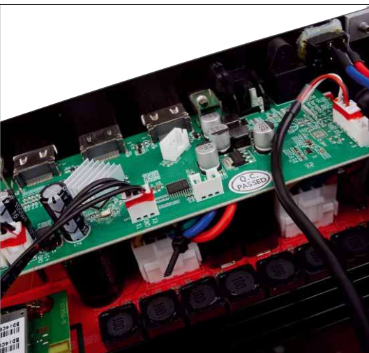
Hier sieht man das Bord mit den Digitaleingängen
