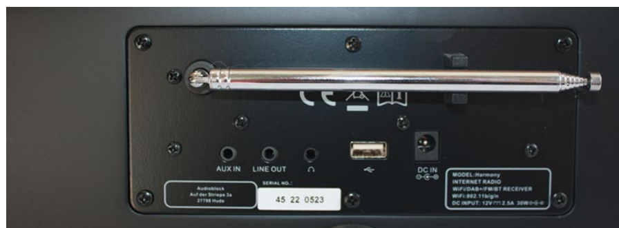
Die funktionale Anschlussausstattung überzeugt. Wir hätten uns allerdings gewünscht, dass die fest verbaute Teleskopantenne auch durch einen externen Antenneneingang ersetzt werden kann
